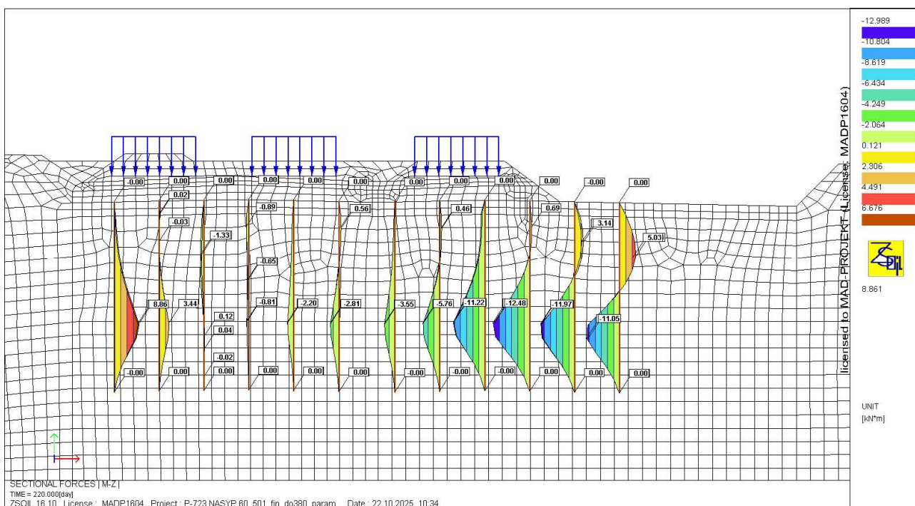
Rys. 6. Momenty zginające w palach w etapie 1 [kNm].
